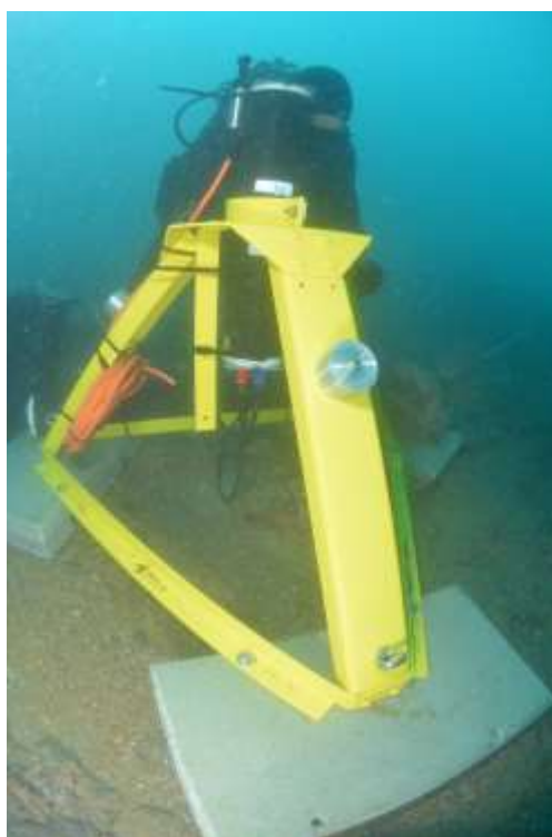
Figure 142 : Photo du déploiement et fixation de l'enregistreur autonome.
